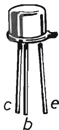
Fig. 4 - I due transistor al silicio, montati nel radoricevitore, pur essendo elettricamente diversi fra loro, sono uguali esternamente. La posizione degli elettrodi è facilmente individuabile facendo riferimento alla piccola tacca-guida riportata sul contenitore metallico del componente.
